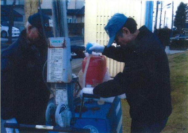
自家発電機へ燃料注入
