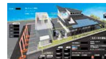
省エネ・再エネ設備と県産材による「ZEB」 ※年間のエネルギー収支をゼロとすることを 目指した建物。
