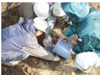
疎水材部の浸透性能調査
