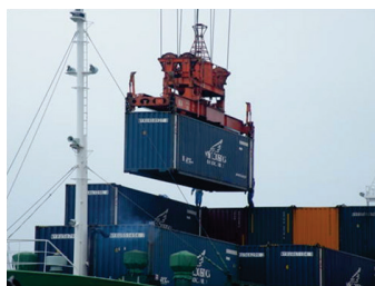
16 ガントリークレーンで荷役される 45 フィートコンテナ
