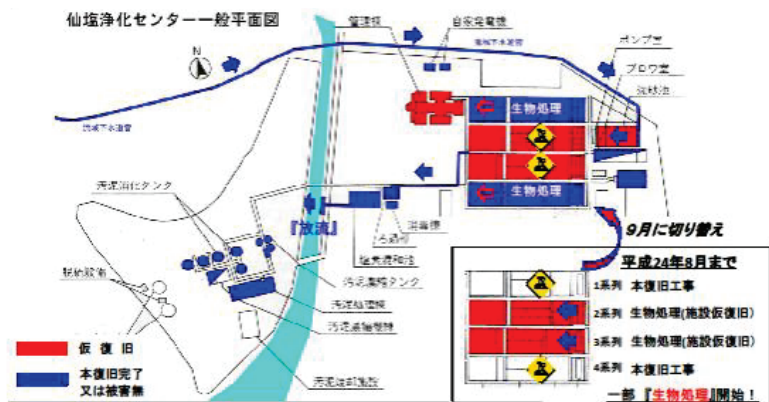
■ 図 4-3-13：仙塩浄化センター施設の仮復旧・本復旧の状況図
