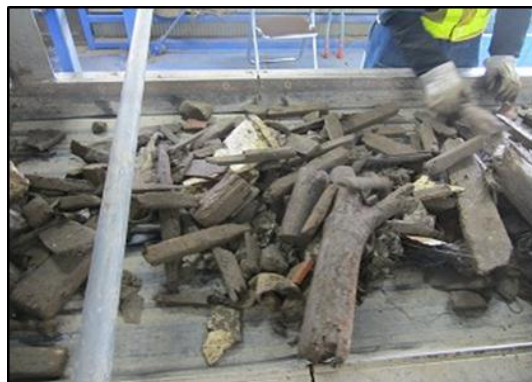
写真3-46 除去された大粒径木くず
