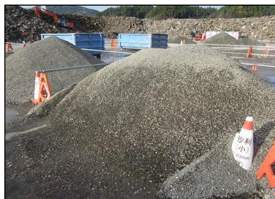
写真3-32 洗浄後再生骨材 (復興資材)
