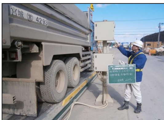
写真3-14 ゲートモニターによる放射能測定状況
