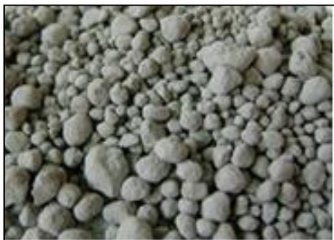
写真2-28 焼却灰の造粒固化による造粒物の再資源化
