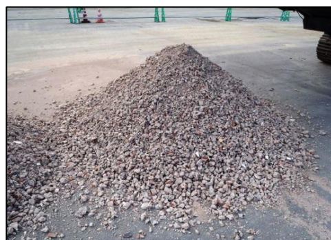
写真2-30 不燃物の混練り固化による再資源化
