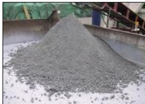
写真2-28 焼却灰の造粒固化による造粒物の再資源化
