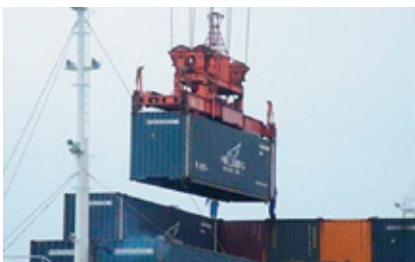
写真:ガントリークレーンで荷役される45フィートコンテナ
