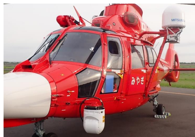
ヘリコプター衛星通信システム (ヘリサット)
