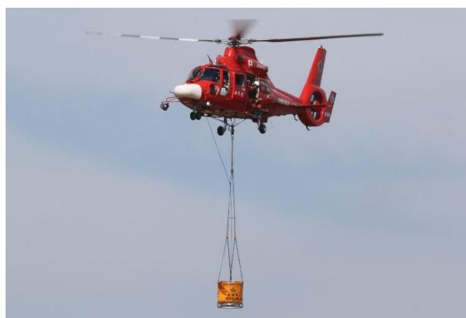
空中消火装置 (消火バケツ)
