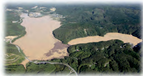
出水時の貯水池の状況(平成 24 年台風 17 号) 貯水池に多量の土砂・流木が流入、高濁度化
