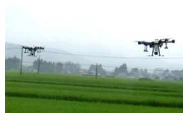
図4 散布用マルチローターの2台協調防除作業
