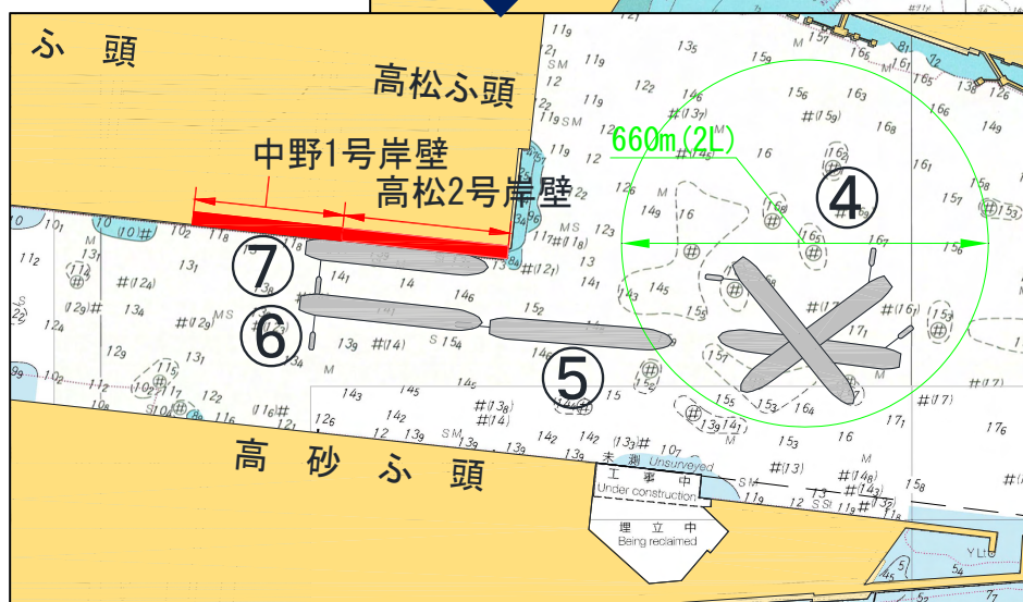
図 1-1(2) 入港操船例図(14万総トン級、出船左舷付け)
