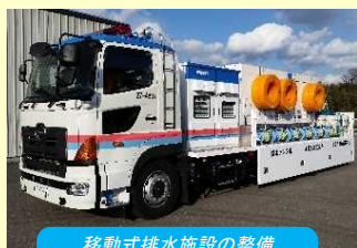
移動式排水施設の整備
