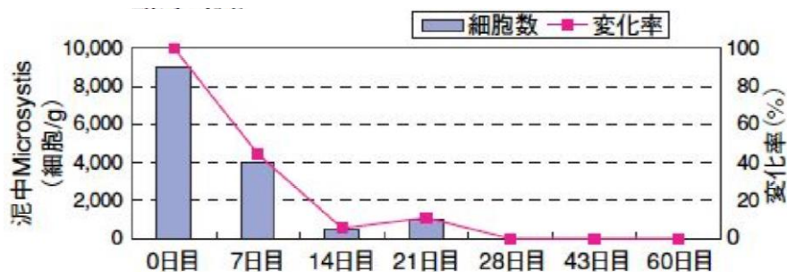
図5 乾燥日数と底泥中のミクロキスティス*細胞数(三春ダム) ※アオコの原因藻類
