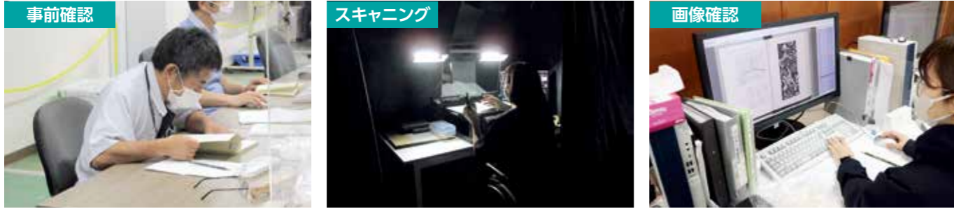
本に汚れや落丁などがなく1ページ1ページ 暗室で全ページをスキャナーで撮影します 目視で確認し、記録します 撮影した画像に汚れ・ほこり・ズレなどがなく確認します
