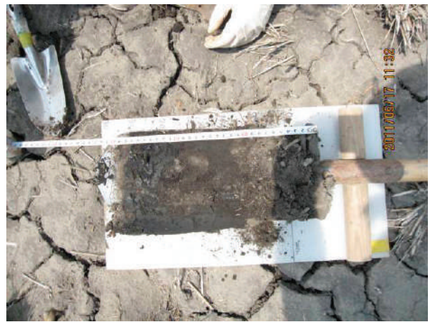
写真 挟み込み引き上げた土壌の断面を写真にとり、堆積物と作土層に分けて採取
