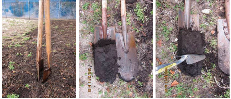
写真 ながいもスコップで挟み込み採土
