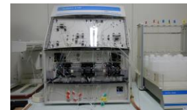
オートアナライザー →リン酸量と窒素量の測定
