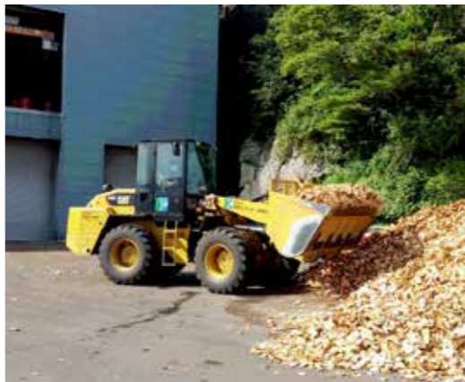
搬入された木質チップ。湿気を多く含んでいるため、乾燥させてから燃料材として使用する
