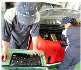
スキャンツールで得たデータを元に、「FAINES（ファイネス）」を参照しながら故障原因を特定する訓練。
