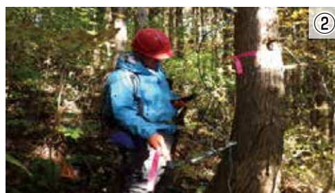
ファコップの上下センサを立木に打ち込み、打撃波の到達速度を計測
