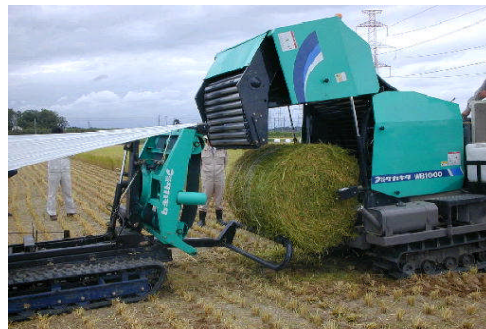
②ロールを直接ロールラックへ排出可能
