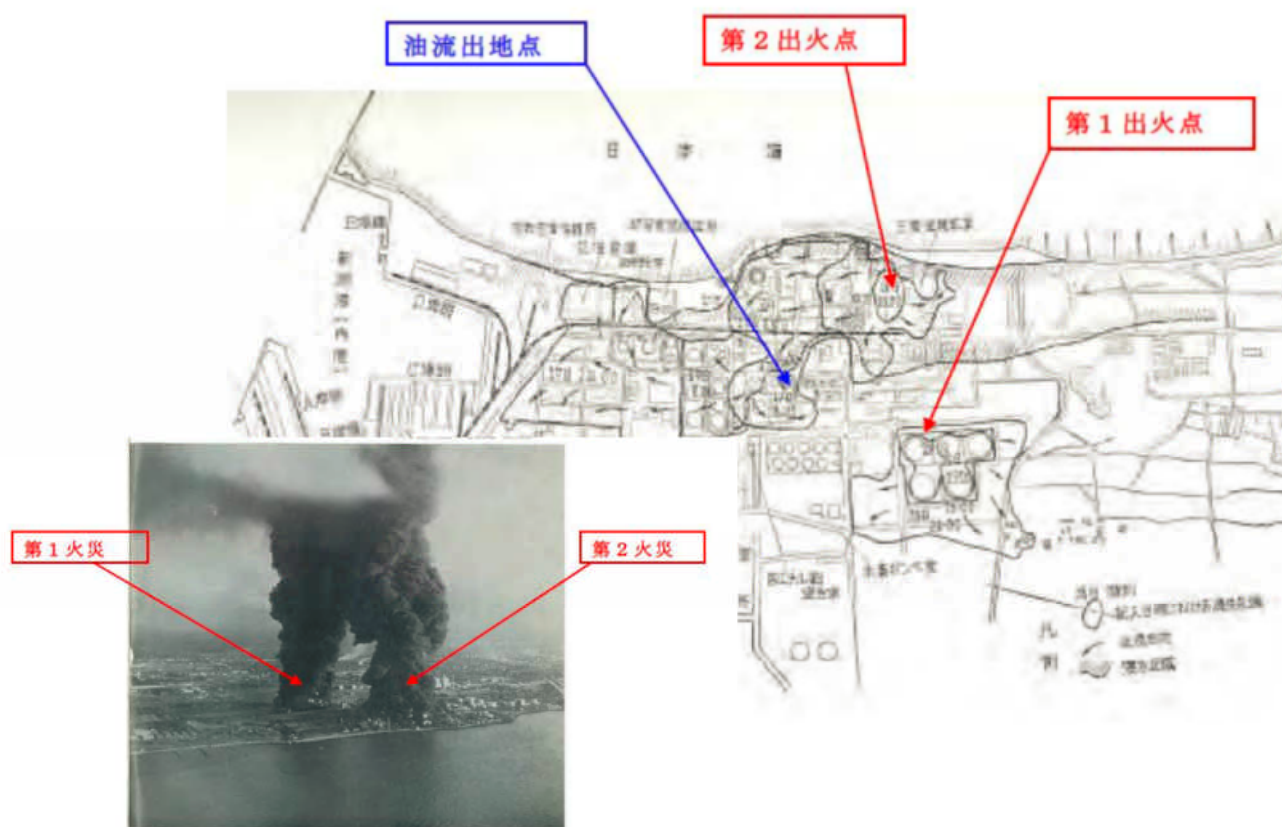
図 6.1.3 新潟地震(1964)での製油所での出火・延焼状況 2
