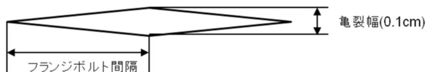
図 2.3.1 フランジボルトの緩みによる流出口の概念図
