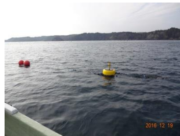
図3 復旧した歌津観測所(水温ブイ)
