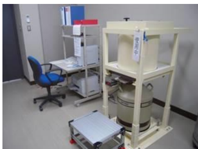
水産技術総合センターに設置されたゲルマニウム半導体検出器(精密検査用)
