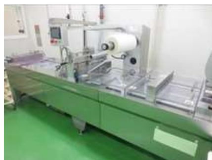
復旧した水産加工設備(自動真空包装機)
