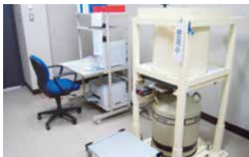
写真 所内に配備された放射性物質精密測定機器 (ゲルマニウム半導体検出器)
