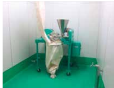
写真 粉碎室（粉碎機）
