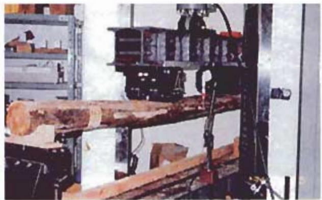
写真2. 曲げ強度試験状況
