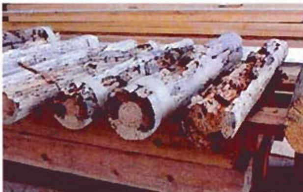
写真3. 施工後5年経過材 (平均材)
