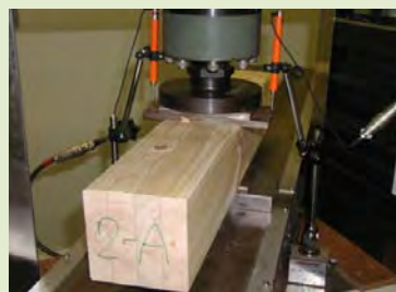
部分横圧縮 (めり込み) 強度試験
