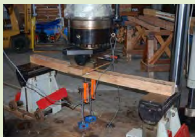
中央集中荷重による実大曲げ試験
