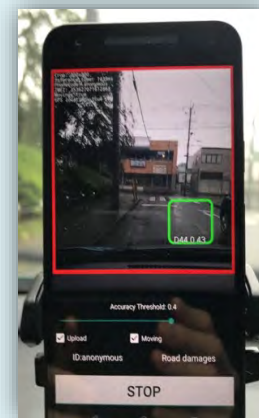
道路損傷自動検出アプリ
