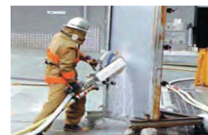
【消防防災科学技術研究推進制度の研究成果(高水圧駆動カッター)】
