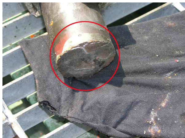
図-3 電気集塵機電磁ハンマー軸の破断
