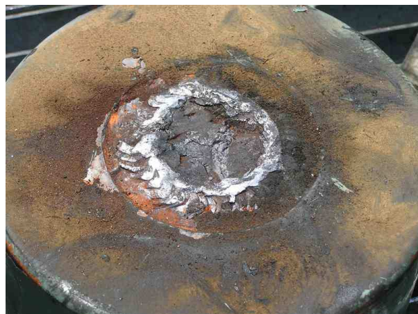
図-4 電気集塵機電磁ハンマー軸の破断面
