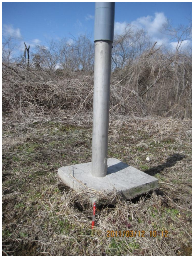
④-2 H16-6 (山の上) ボーリング孔約 15cm 浮き上がり
