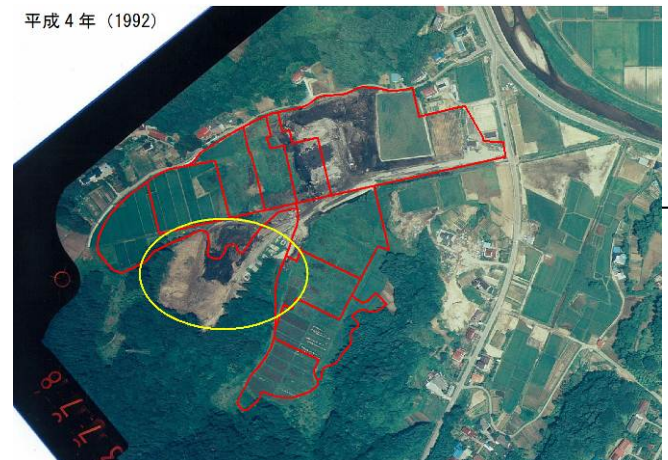
平成4年(1992) 第2工区まで埋め立てが行われている。第6工区の一部やその山側をピートストックエリアや浄化槽施設エリアとして利用するエリアでは伐採や表土剥ぎなどの土地改変が行われている。
