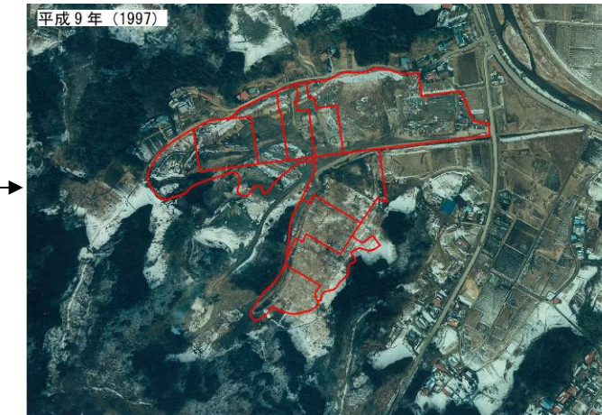
平成9年(1997) 第1~第6工区, 処分場外であるピートストックエリアまで埋め立てが行われている。焼却施設の下段(第10工区の西側)では伐採などが行われ地形改変されている。処分場と北方の盛田地区の谷とを結ぶ道路が建設されている。
