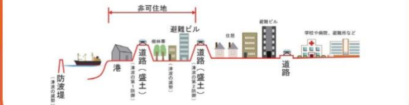
▲市街地の断面イメージ（高盛土構造の道路により、津波の減勢を図る）
