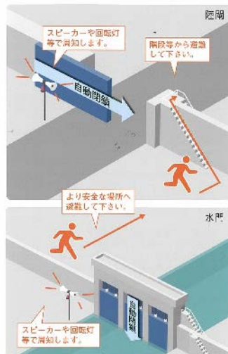
宮城県は、通信ネットワークにより水門・陸閘を自動で閉鎖し、津波被害を軽減する取り組みを進めています。安全かつ迅速・確実な津波防災を実現するために、水門・陸閘を閉鎖して被害を軽減する取り組みを進めています。津波注意報・津波警報・高潮警報が発令されたら、迅速かつ安全に水門・陸閘を閉鎖して被害を軽減してください。
