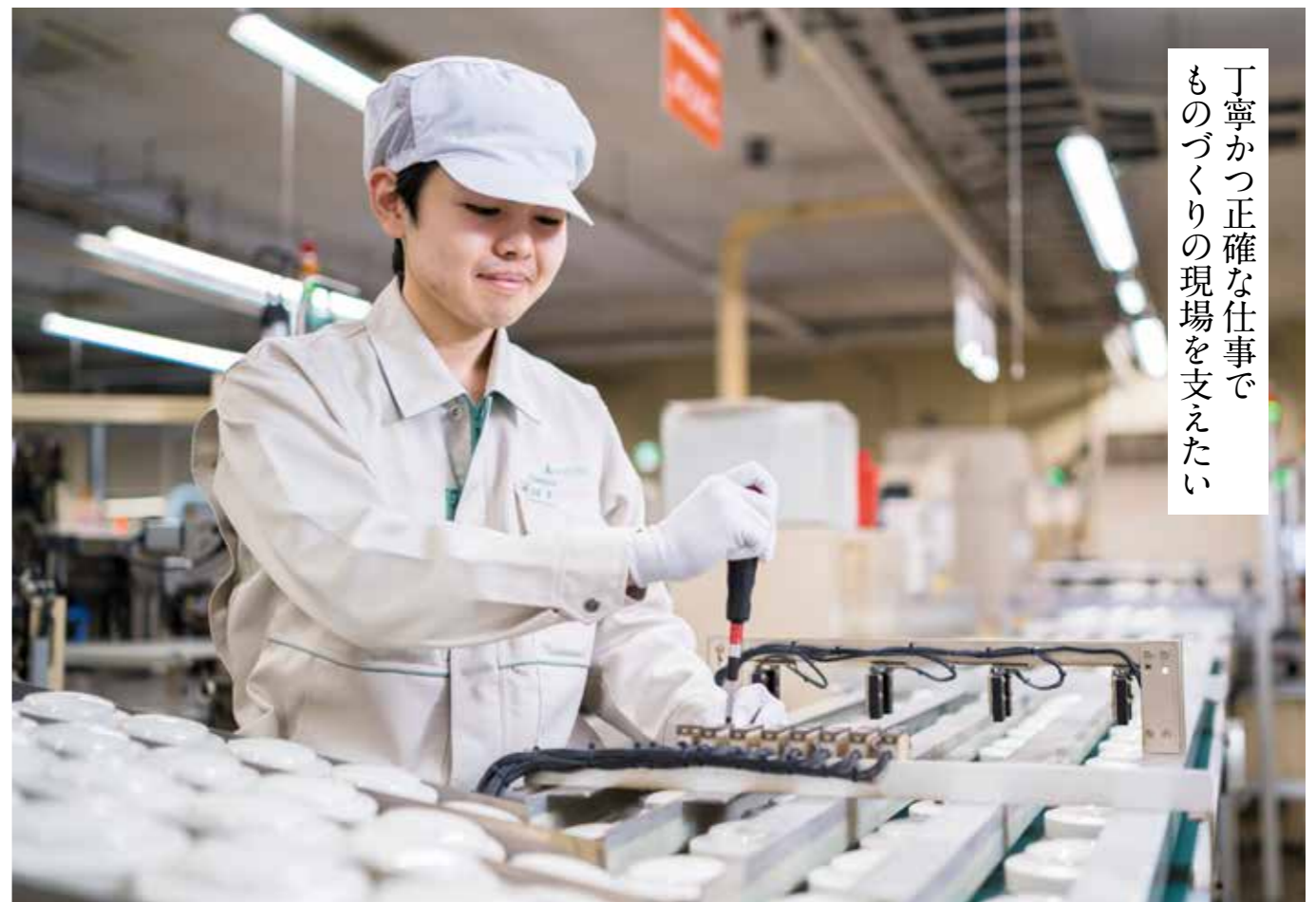
熱感知器の自動生産ラインに取り付けられたセンサーの調整を行う佐藤潤一さん
