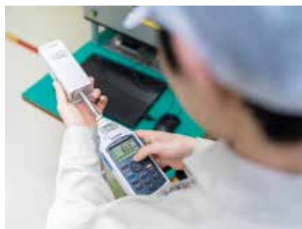
測定器の信頼性を確認する校正作業。基準器との誤差が大きい場合は、専門業者に調整を依頼する
