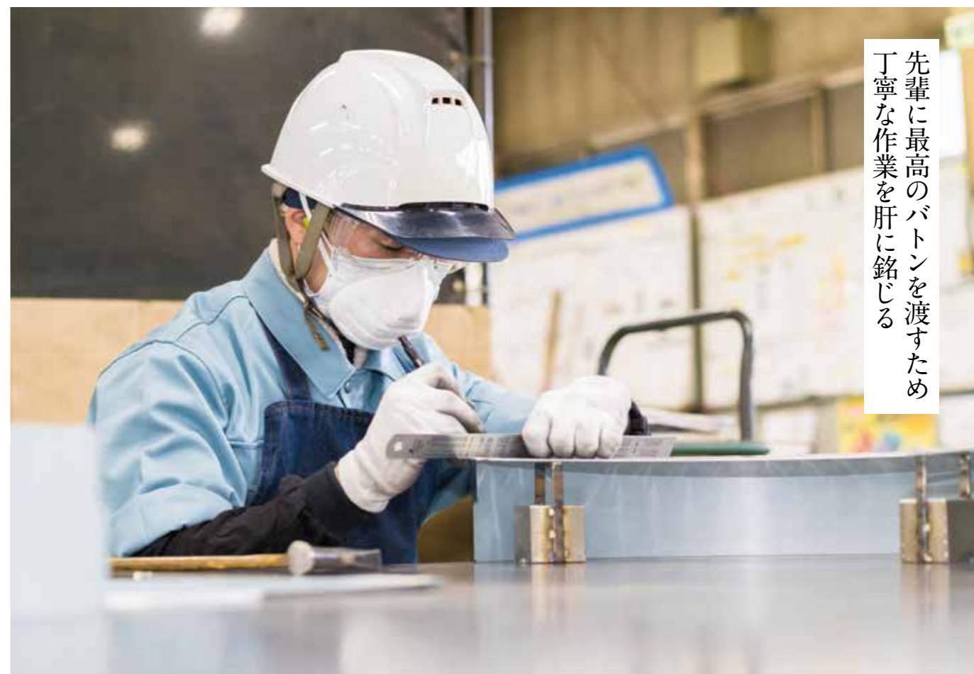
溶接した部分に定規を当てて、金属のひずみが見られないか確認する阿部直希さん
