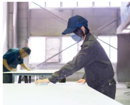
塗装前の下地処理を行う。大きな看板の隅々まで磨いて塗装面を整える
