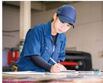
図面を参考にしながら、切断する材料の寸法を算出する「寸法出し」を行う
