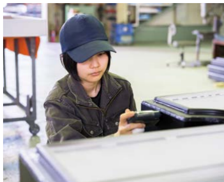
乾燥した塗料の厚さ（膜厚）を測定する。適正な膜厚は、塗料によって異なる
