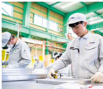
グリル製造ラインで検査を行う。製品が規定通りのサイズか確かめる
