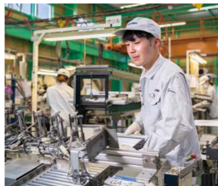
グリル用フレームに仮止めした羽根を、本止め専用の機械で固定する
