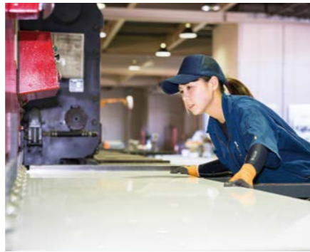
「ベンダー」と呼ばれる機械で、材料の曲げ加工を行う。曲げる角度は自由に設定できる
