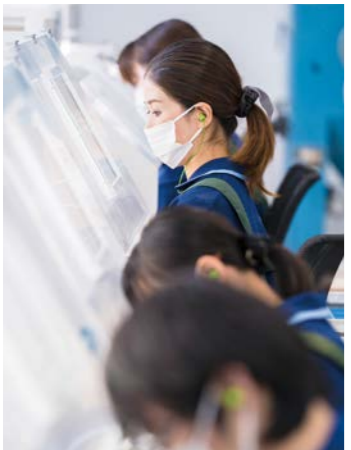
研磨で生じる金属粉の拡散を防ぐため、作業用のボックス内で行う
