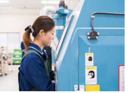
細かい粒子を吹き付け研磨するプラスチック加工は最終仕上げの工程だ
