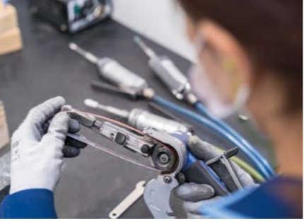
やすり付きベルトを工具に取り付ける。研磨加工では様々な工具を使い分ける
