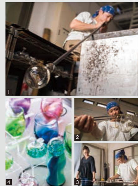
1. 竿に息を送りガラスの塊を一気に膨らませる 2. 竿を回転させながら、専用の道具を使ってガラスの口の形を整える 3. 時間が勝負のガラス工芸では、共同で作業することがある 4. 工房のギャラリーにはガラス万華鏡(右手前)をはじめ、カラフルな作品で彩られる
