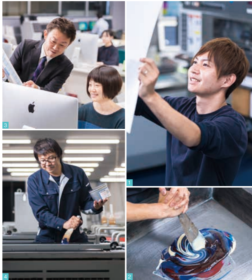
1 2級印刷技能士の松井翔さん。「製品の仕上がりを確かめながら、ものづくりの楽しさとやりがいを実感している」と話す 2 何種類かのインキを混ぜて作る「特色インキ」の調合作業。技能検定の実技試験でも技術が問われる重要な作業だ 3 印刷営業の高い知識と技能を持った「印刷営業士」の大場秀克さん(左)と、パソコンで印刷物のデザインやレイアウトをする知識を持った「DTPエキスパート」の高橋幸恵さん(右) 4 オフセット印刷機にインキを補充する1級印刷技能士の遠藤光浩さん。ヘラを使って全体をならしながら、インキの硬さや流動性を確認する
