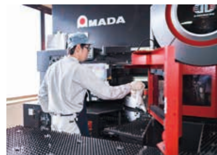
自動タレットパンチプレスにセットする金型のホルダを清掃する。こまめな整備が大切
