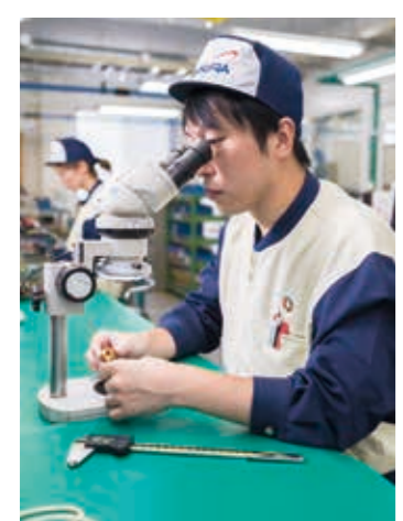
製品にキズなどがいないか顕微鏡で外観検査を行う
