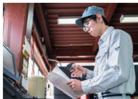
伝票に記載されたバーコードを読み取り、加工データを自動タレットパンチプレスに送る
