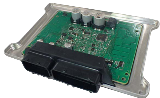
自動車のエンジン・コントロール・ユニット。ドライバーが操作するアクセルやトランスミッションなどの状況、気温や気圧などの環境条件を検知し、エンジンを最適な運転状態に保っている
