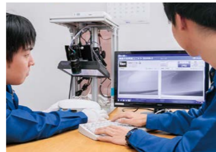
「SSMM-1」を操作する。スリット光を照射した検査対象物をカメラで撮影し、モニターで傷などを検出する
