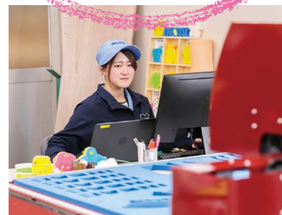
パソコンでキッチンスポンジのデザインをする。デザインが決まると試作用の機械（手前）にデータが送られ、デザイン通りのスポンジが抜き出される
