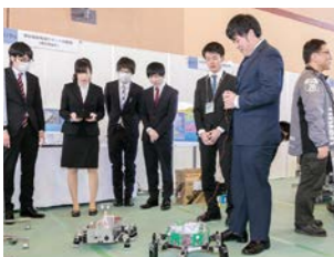
害獣被害軽減ロボットは、斜面の移動や遠隔操作、カメラ監視機能を備わっている
