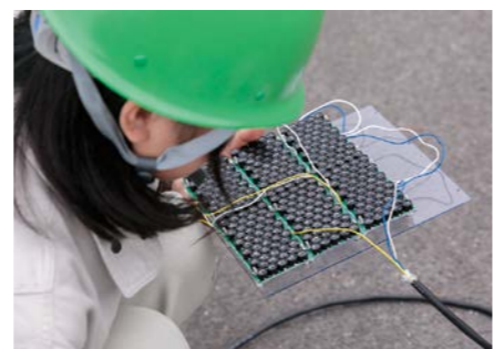
装置の中には、小さなパラメトリック・スピーカーがたくさん取り付けられている
