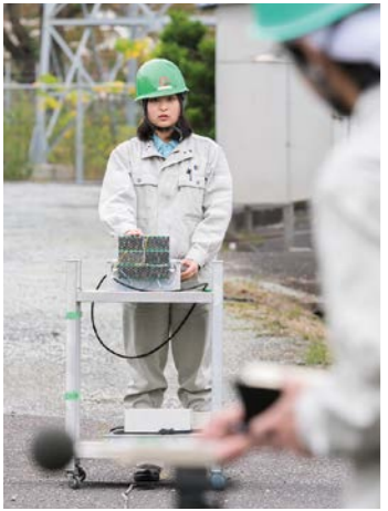
数十メートル先に設置した集音マイク(手前)が音を拾うことで、試作品の性能を確認できる
