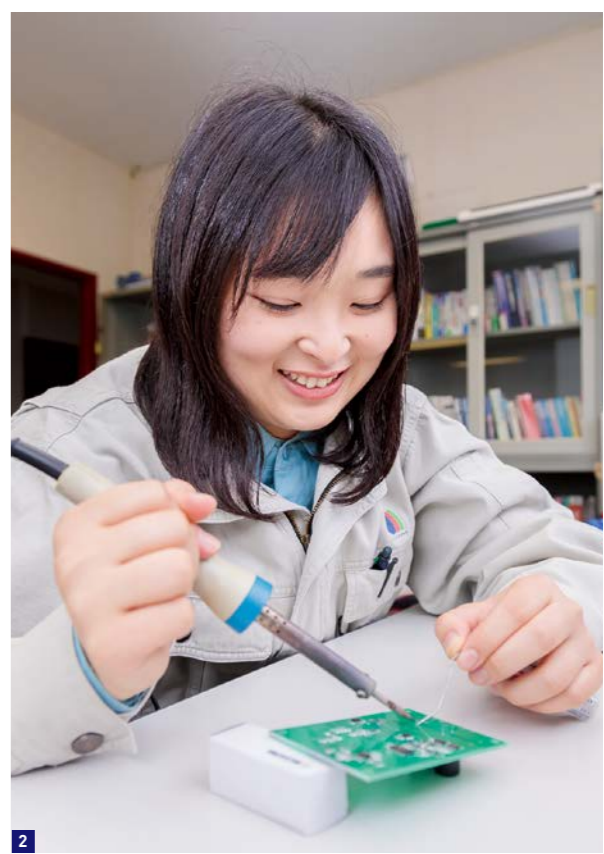
1 「エレクロー®」の試作品をテストする二階堂綾香さん。箱形の装置から鳥が嫌がる音を発生させる 2 電子基板に部品をはんだ付けする。「スピーカーのはんだ付けは、リズムにのってすることができて楽しかったです」と話す
