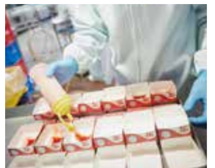
紙パックの接着の状態をチェック。抽出したサンプルの上下を切り取り、染色液を注入。万が一不具合があれば、色が変わり一目で分かる
