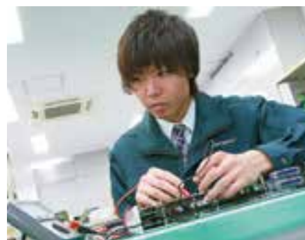
テスターで組み上げた機器ユニットのチェック。電子部品と基板との接続がしっかりできているかを確認する
