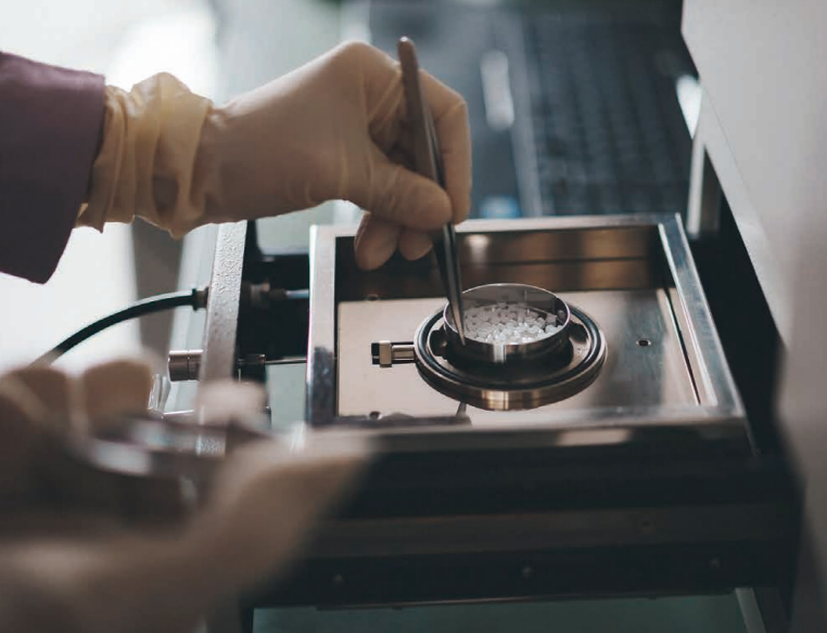
高感度 CCD カメラを利用するものもあるが、こちらは光電子増倍管を用いた CLA。光電子増倍管の上に試料を置いて測定する
