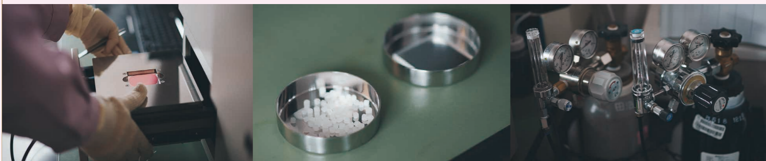
a: 試料室は引き出し式が採用されている b: シャーレに入るものであれば対象は固体、液体、粉体を問わない c: 目的に合わせて測定の際に酸素や窒素を使う
