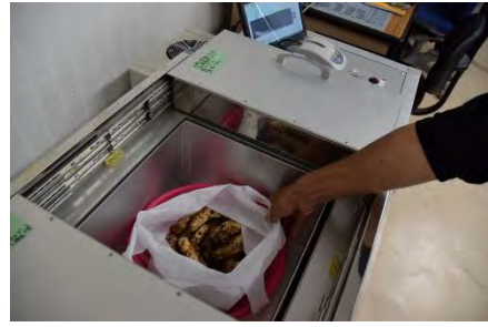
(非破壊検査機による検査の状況 (マツタケ))
