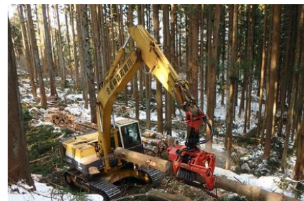
高性能林業機械による間伐
