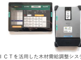
ICTを活用した木材需給調整システム (土場から出荷情報を入力するタブレット)
