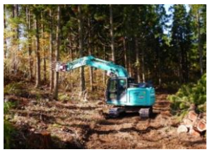
高性能林業機械による間伐
