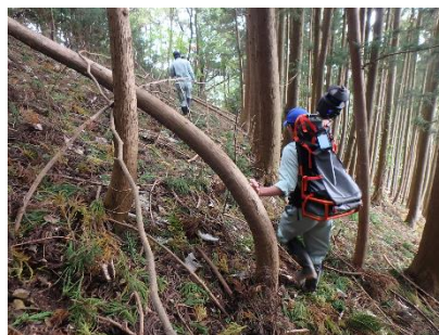
3Dレーザースキャナーによる森林調査 3Dウォーカー
