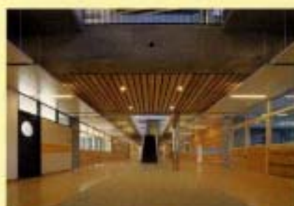
メモリアルモール（廊下と天井に鳴子のスギ材を使用）
