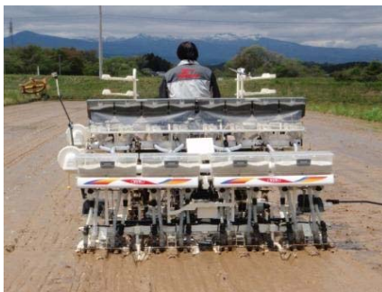
多目的田植機による 湛水直播作業の様子
